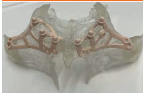
Ryc. 10 Druk 3D implantów oraz struktury podtrzymującej
